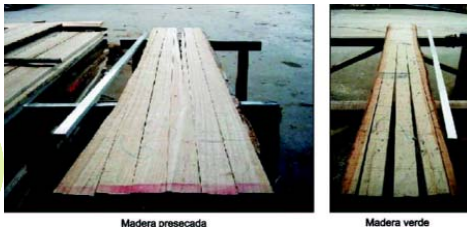
FIGURA 10. EL PRESECADO DE LA MADERA PRODUCE UN IMPORTANTE EFECTO EN LA REDUCCIÓN DE LAS DEFORMACIONES QUE TIENEN LUGAR DURANTE EL REASERRADO DE LA MADERA
