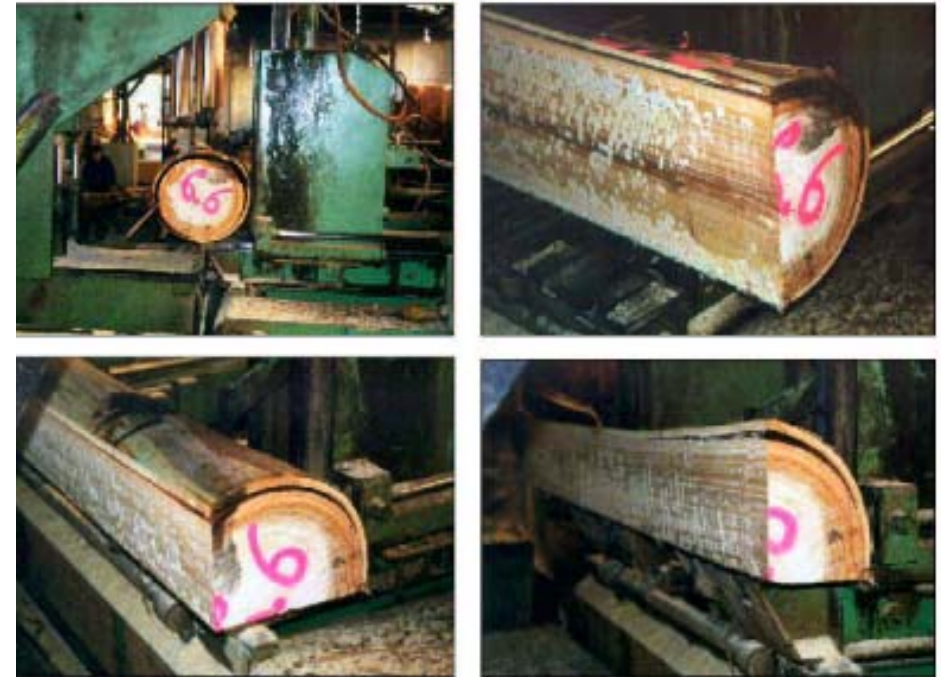
FIGURA 5. ES POSIBLE EVITAR EL DESARROLLO DE FENDAS REALIZANDO UN PRIMER CORTE POR EL CENTRO DE LA TROZA, PARA CORTAR POSTERIORMENTE «AL HILO» CADA UNA DE LAS SEMITROZAS
