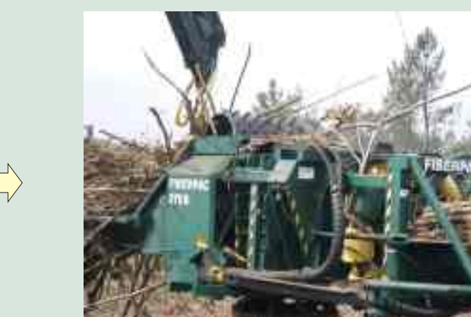
3- Corte de la paca a la longitud deseada.
