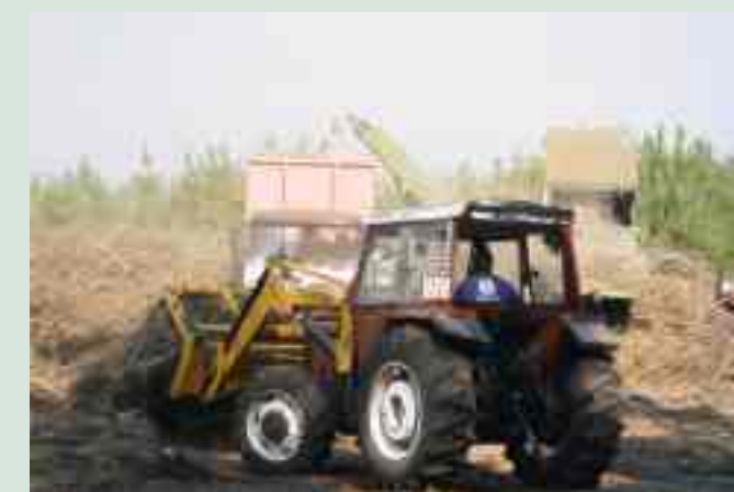
2- Acercamiento del material con tractor con garra frontal.
