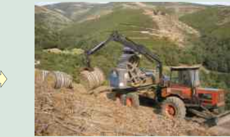
3- Extracción de la bala de la cámara de compactado.
