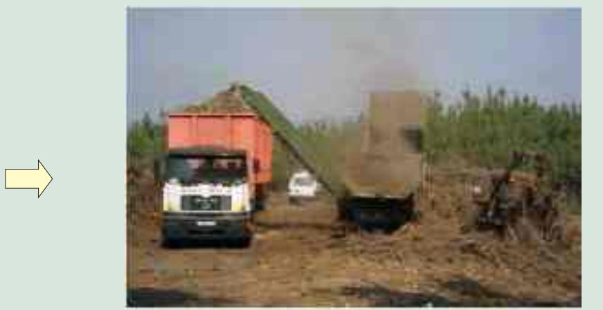
3- Descarga de astilla sobre camión.
