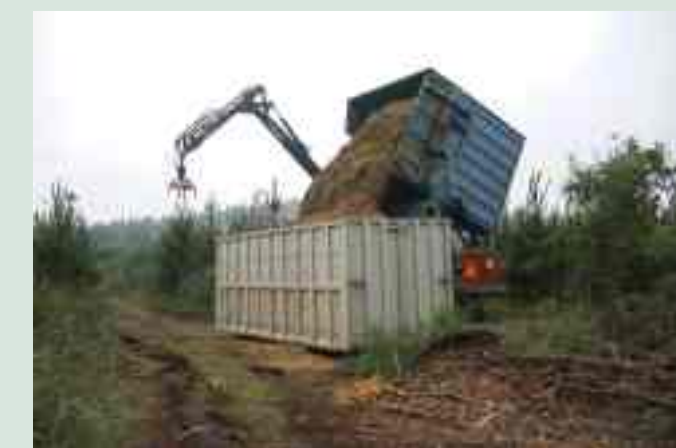
3- Descarga astilla sobre contenedor.
